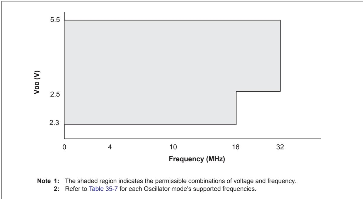
**FIGURE 35-2: VOLTAGE FREQUENCY GRAPH,  $-40^{\circ}\text{C} \leq T_A \leq +125^{\circ}\text{C}$ , PIC16LF18324/18344 ONLY**
